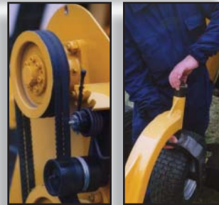
1 Tendeur de courroie automatique Automatic belt turnbuckle
